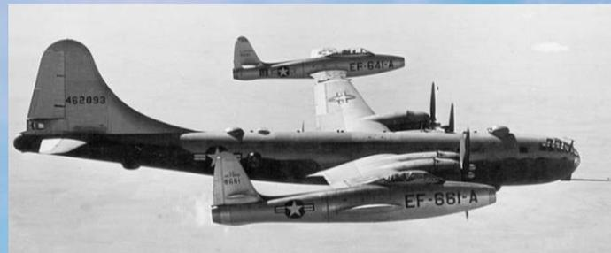
EF-84D试验机在测试由轰炸机拖曳进行远程飞行的可行性
