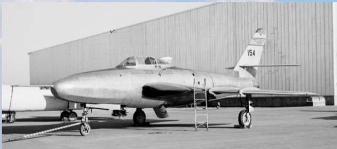
YRF-84F原型机，机头将被用于安装相机
