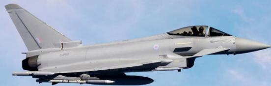
现役的台风战斗机虽然未采用矢量推力技术，但凭借优异的气动设计和先进的飞行控制计算机，再加上EJ200发动机的强劲推力，使其获得了不亚于美俄最先进战斗机的超机动性能。
