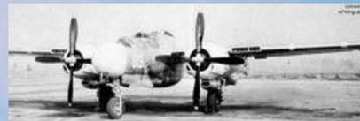
1943年11月11日诺斯罗普被批准研制“黑寡妇”改进型——XP-61C。最大的改进是换装了涡轮增压的R-2800-77涡轮增压发动机，紧急战斗功率2800马力。
