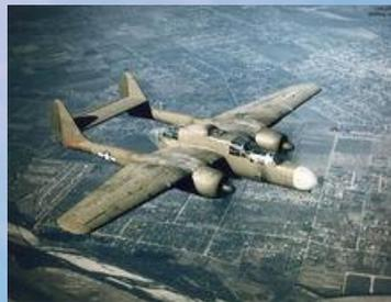
P-61A是“黑寡妇”的第一种生产型，1943年10月第一架P-61A-1-N0下线。该机增加了座舱盖和透明尾椎的隔框数量。此外原型机上的镁铝合金焊接制造的尾撑也被更传统的铝合金尾撑取代。与XP-61和YP-61的全机黑色涂装不同，P-61A涂上了陆航的标准橄榄绿。
