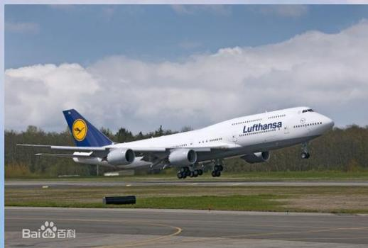
作为对竞争对手空中客车A380大型客机的回应，2005年11月14日，波音公司正式启动了新型波音747-8项目，747-8将采用波音787的技术，加强747的载客和载货能力，。装备用电气GENx发动机，先进主机翼设计，提高燃油效率，改进运营经济性。
