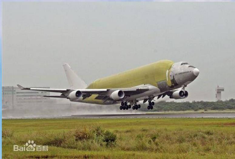
超大型货运机型，考虑到将波音787组件从全球合作伙伴的工厂运往华盛顿州埃弗雷特的波音787总装厂，在2003年10月发起该项目，利用747-400客机进行改装，在外形上，类似空中客车A300-600ST（白鲸），机身有大的隆起部分，使货舱空间增大，适合运载大部件。
